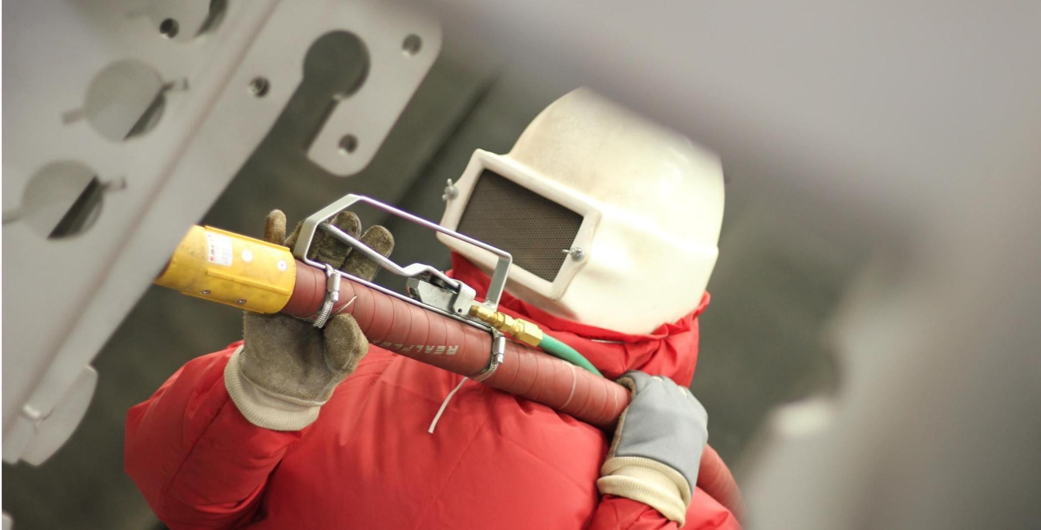
A Cym Materiales SA fabrica **cabines** completas para **jateamento** de uma grande variedade de peças, podendo adapta-las para eliminação de todos os tipos de revestimento e contaminantes, tais como pinturas velhas, areia de fundição etc. Simultaneamente com a remoção dos contaminantes, melhora tanto o perfil de rugosidade como o aspecto visual das peças, dando maior ancoragem para aplicação de qualquer tipo de revestimento ou pinturas
