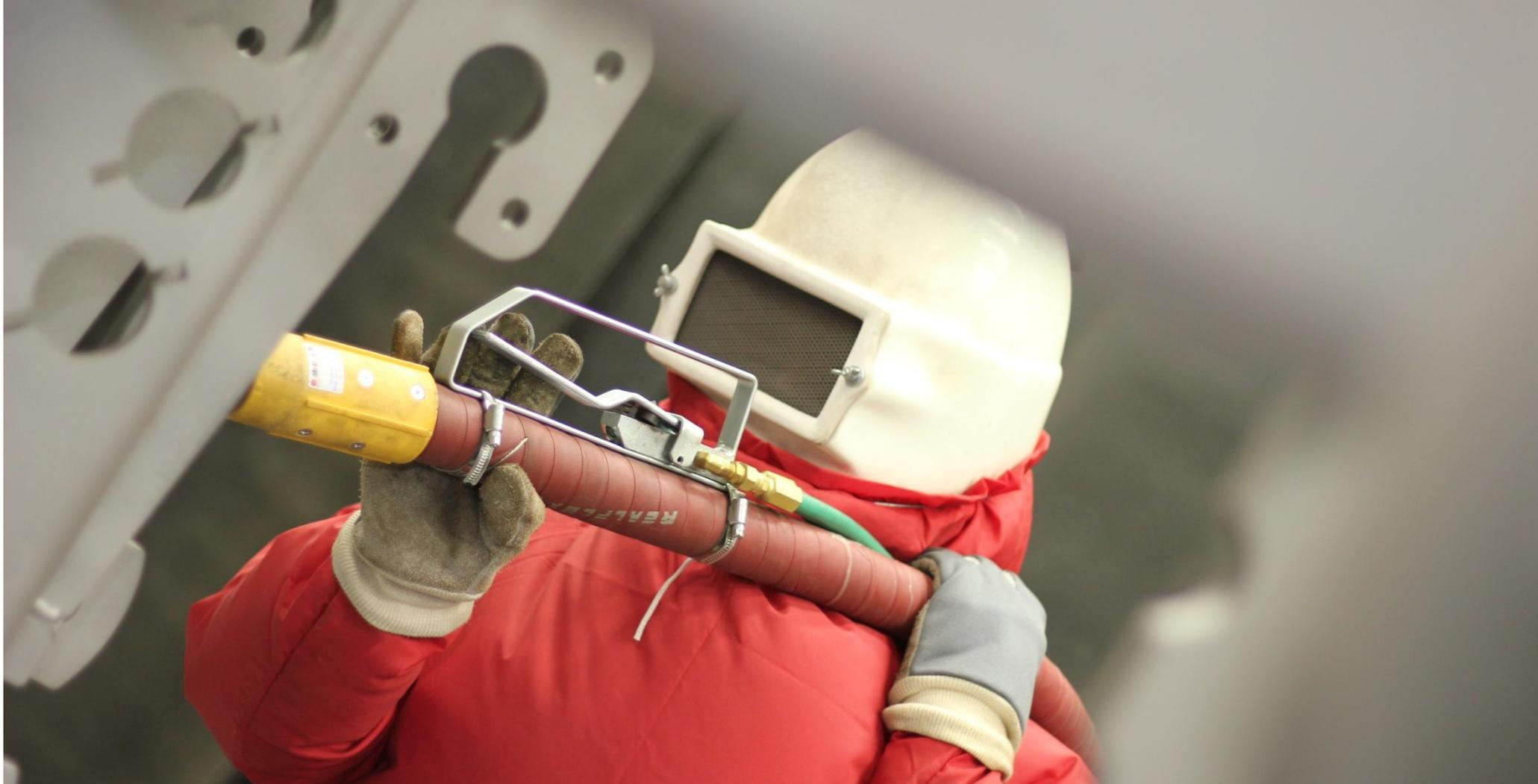
Cym Materiales SA fabrica cuartos completos para el **granallado** de una alta variedad de piezas, pudiéndolos adaptar para el **tratamiento de todo tipo de revestimiento y contaminantes** como ser pinturas viejas, laminillas, arenas de fundiciones, etc. Simultáneamente a la remoción de contaminantes el **granallado da perfil de rugosidad** para mejorar tanto sea el aspecto visual de la pieza tratada como así también dar un anclaje para aplicar cualquier tipo de revestimiento o pinturas
