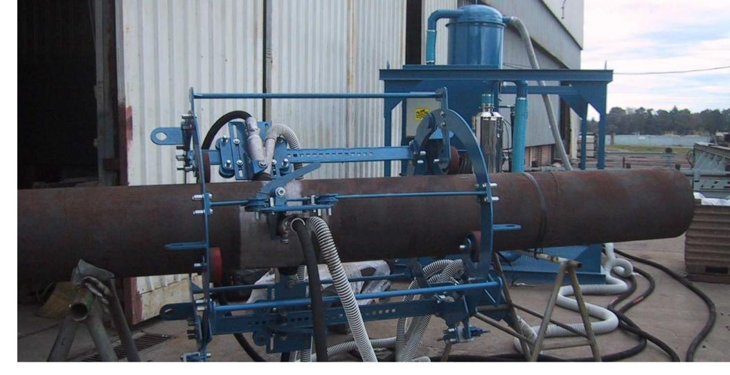
Cym Materiales fabrica equipos de granallado portátiles por circuito cerrado modelo CY-VAC para el granallado de superficies metálicas, maderas, concreto, etc.
