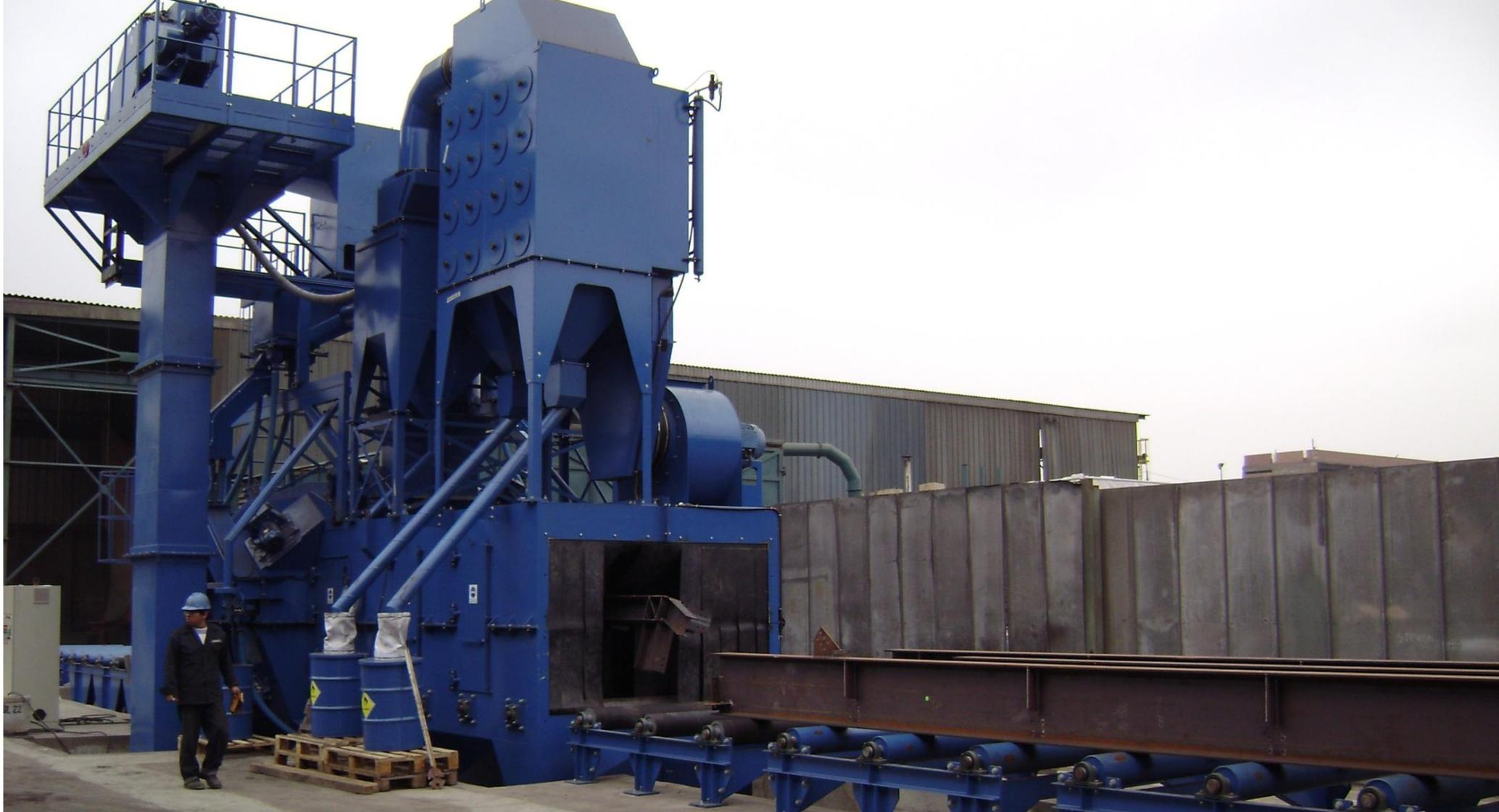
Cym Materiales SA fabrica **equipos de granallado** automático de pasaje continuo y **cuartos de granallado manual** para el procesamiento de **estructuras soldadas, perfiles, barras, flejes, chapas y tubos** adaptándose a las necesidades de cada cliente.
